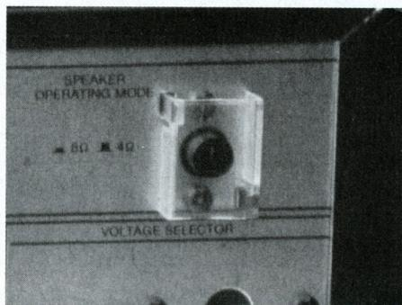
Con questo pulsante è possibile passare da un livello di alimentazione «basso», atto a minimizzare la dissipazione di calore in quei casi ove non sia richiesto il massimo dispiegamento di potenza ad uno più elevato, con il quale lo stadio finale riesce a sfoderare le notevolissime prestazioni descritte nel riquadro delle misure.
